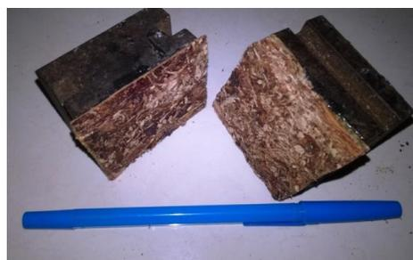
Gambar 16. Kerusakan contoh uji pengujian IB
