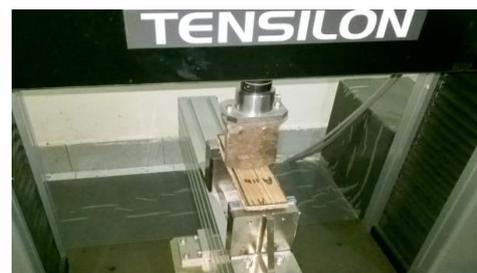
Gambar 14. Pengujian MOE dan MOR dengan mesin UTM
